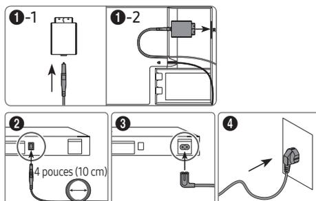
Reportez-vous à l'illustration et connectez le MICRO LED et le boîtier One Connect à l'aide du câble One Connect fourni avec les composants.
